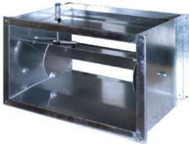
Compuerta de regulación automática de flujo de aire constante sin necesidad de aportación de ningún tipo de alimentación ni control externo, ajustándose a las posibles variaciones de presión del sistema para garantizar el caudal predeterminado en fábrica según las necesidades determinadas del proyecto o por el ajustado manual a pie de obra mediante un dispositivo de calibrado.
